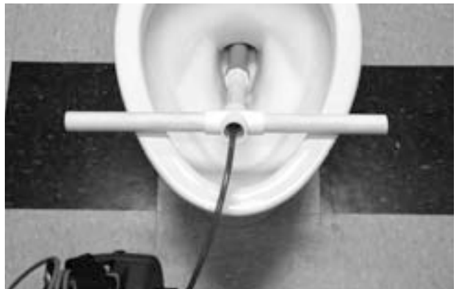
Abbildung 24 – Verwendung eines PVC-Führungsrohrs
