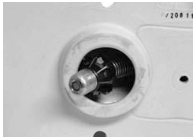
Abbildung 21 – Kamerakopf mit Kugelführung in der Wendung
